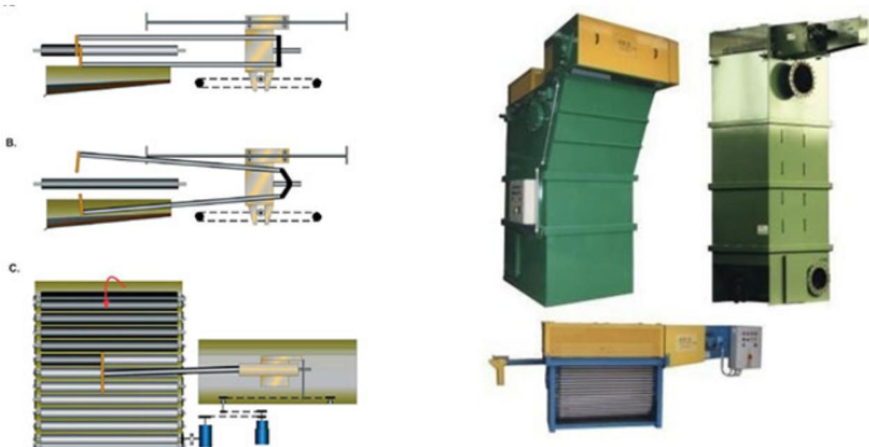
磁棒式过滤装置产品介绍: 1、棒式磁棒式过滤装置是利用磁化原理滤除油箱液中铁磁性污染物的磁性滤油器。2、采用具有高矫顽力即高磁场强度的永磁材料和反铁磁性材料组合而成, 其外罩为不锈钢套管。3、在磁路上设计成高效率的相斥排列式周期磁场, 具有很高的恒定磁场强度, 不但能吸附住铁、钴、镍及其合金和铁氧体化合物, 而且还能够吸附某些弱铁磁性的杂质颗粒。4、磁棒式过滤装置具有设计新颖, 结构先进, 性能优良、吸附力强、在线清洗好, 使用寿命无限等明显特点5、适用于机床加工设备、工程建筑机械、车辆船舶装备、矿山冶金机械、农林轻工机械用液压(润滑)油箱和齿轮箱。6、用于液压油箱时, 可增加泵、马达元件寿命200%;当用于齿轮箱时, 可增加齿轮寿命一倍以上;用于切削液, 可大幅度提高刀具寿命。炼钢厂冷轧乳化液磁棒式过滤设备供货报价棒式磁棒式过滤装置是利用磁化原理滤除油箱液中铁磁性污染物的磁性滤油器。
